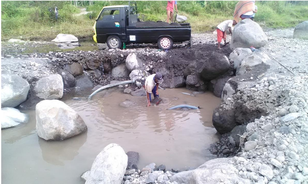
Gambar 4.2 Penambangan Pasir tradisional dengan Menggunakan Mesin diesel untuk memisahkan pasir dan batu
